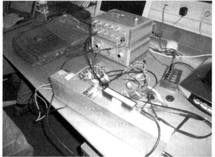
24 GHz Empfängerrauschzahlmessung, OE3WOG (2,1 dB)
